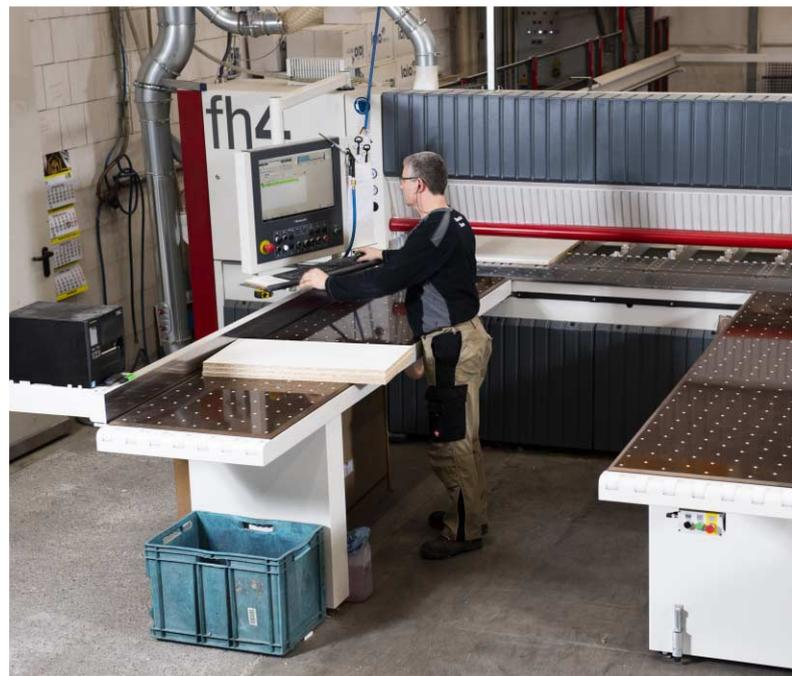
▼ Plattenlängen von bis zu 5600 mm können bearbeitet werden
